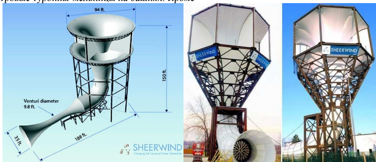
Рис. 1. Башня-ветросборник проекта Invelox.
